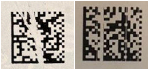
Нарушение целостности КМ*
